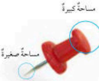
الشكل (4): ينشأ ضغط كبير عند الراس الحاد؛ عند التأثير بقوة صغيرة المقدار.
