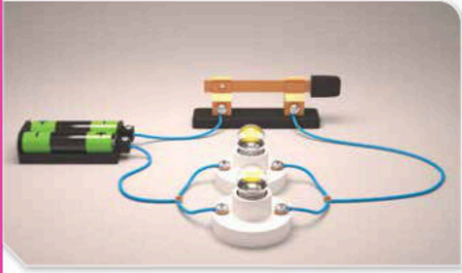
الشكل (12): توصيل المقاومات على التوازي.
