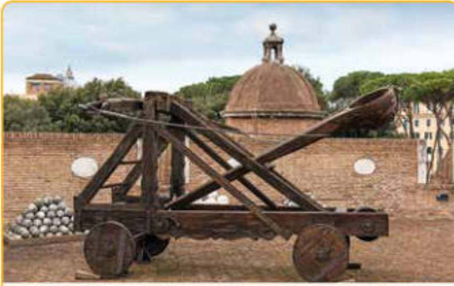
المنجنيق: آلة حربية قديمة، تُستخدم في حصار القلاع والحصون، تُرمي الحجارة الثقيلة على الأسوار لهدمها واقتحامها.
