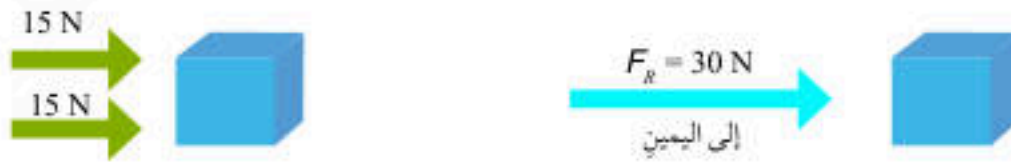
الشكل (10): القوة المحصلة تساوي مجموع قوتين تؤثران بالاتجاه نفسه.
