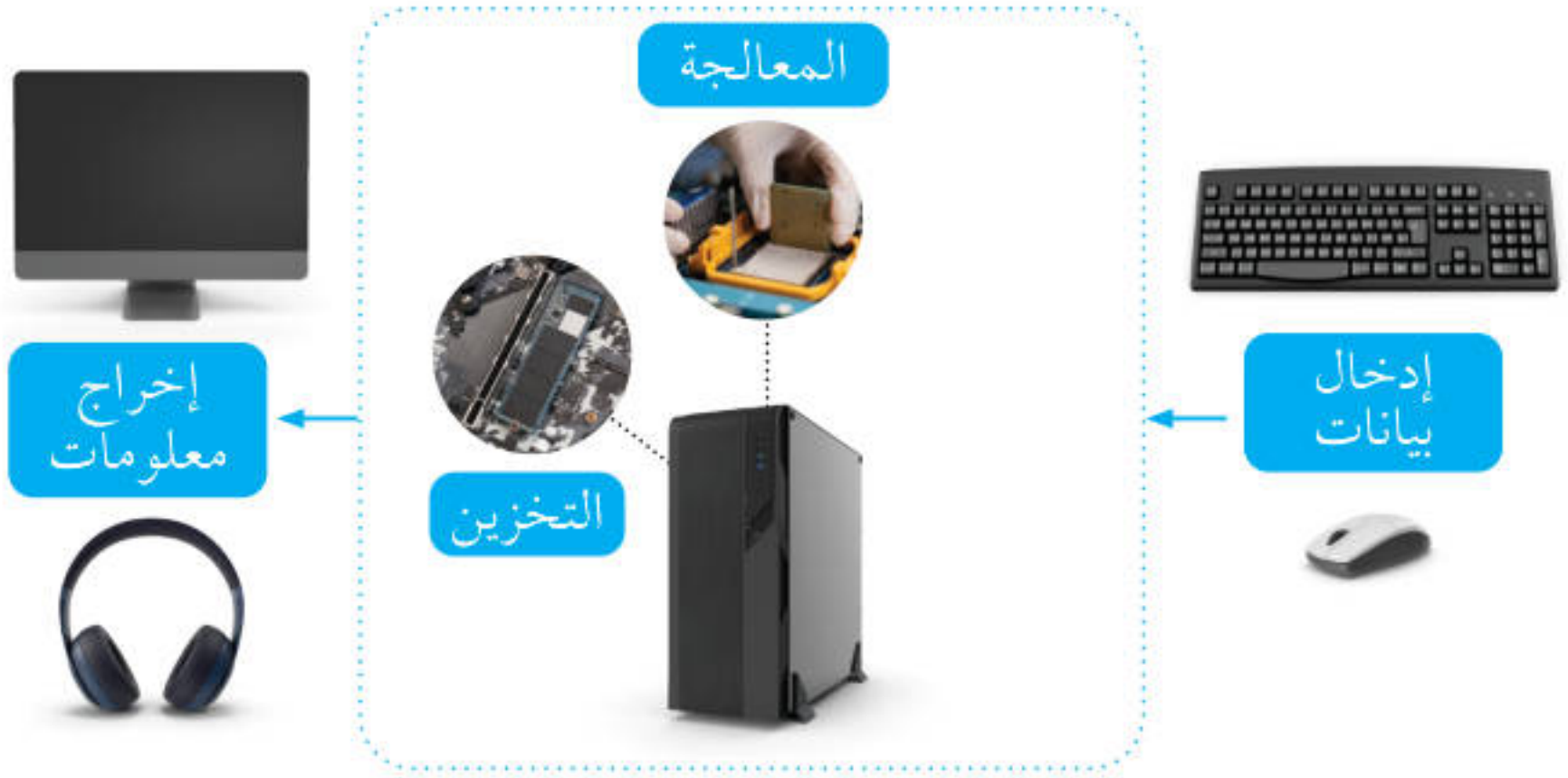
الشكل (1-1): رسمٌ توضيحيٌّ لمبدأ عمل جهاز الحاسوب.
